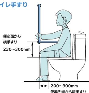
座った状態での使用を考慮し、下端の高さを床から650mm程度に下げる必要があります。縦手すりは、立ち座りを容易にするため、便器の先端から少し前方に設置することが望ましいです。
