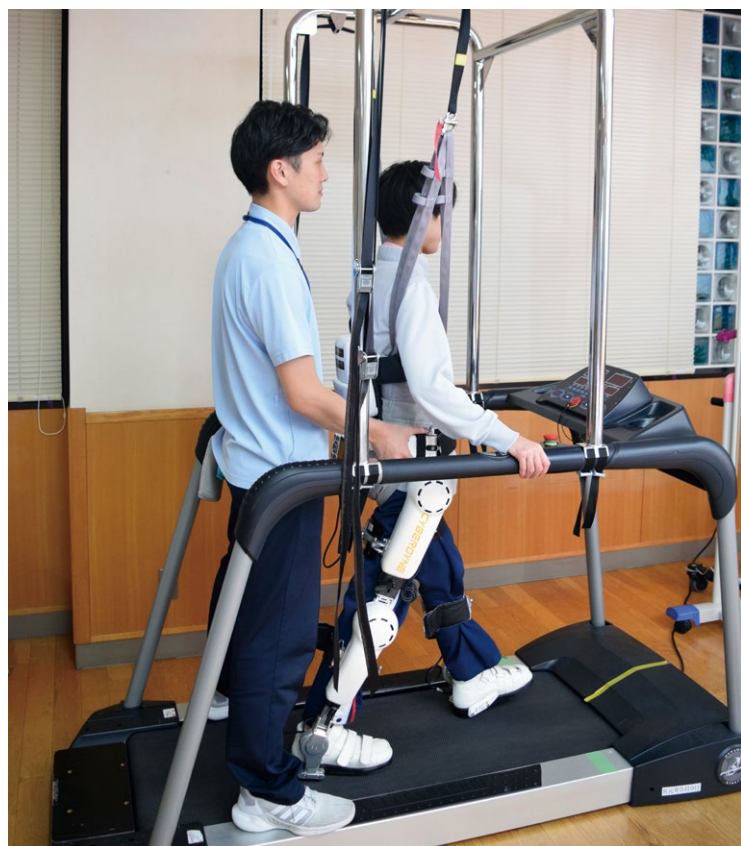
HAL®下肢タイプを装着した歩行練習の場面。HAL®を装着した歩行練習を実施する際には、免荷（身体を支え負荷を軽減する）装置を搭載したトレッドミル（写真内装置）や歩行器を併用して使用します。
