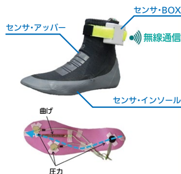
開発中のウェアラブル端末はシューズ型。足の裏だけでなく、足首にもセンサーがあるのが特徴。
